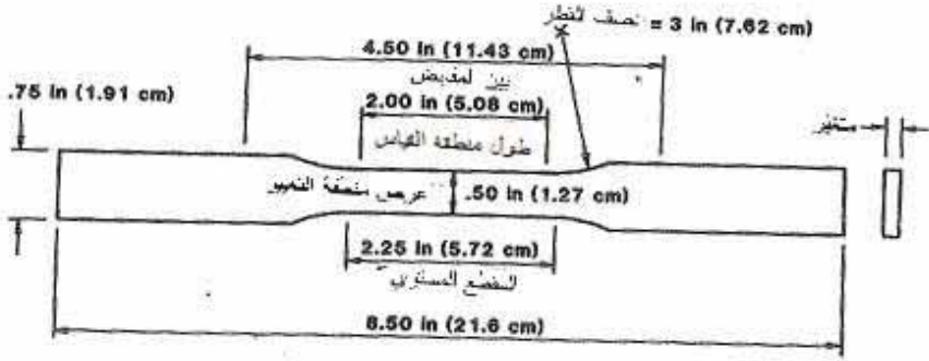
الشكل 21-2 عينة شد وفق المواصفة ASTM D 638
