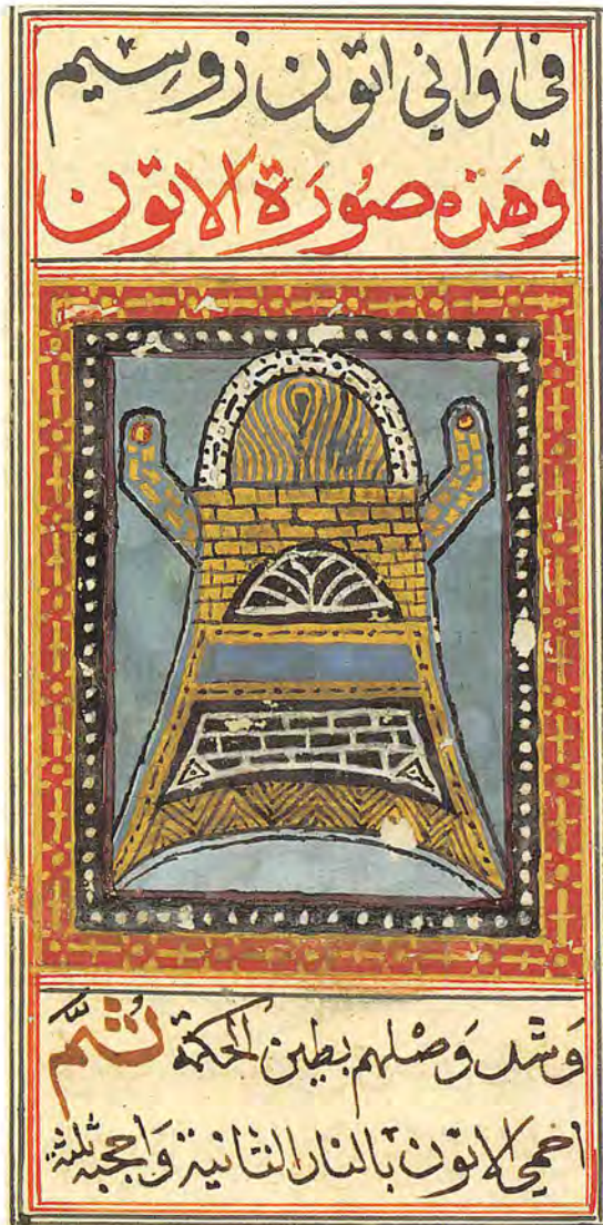
مخطوطة عربية من القرن السادس عشر تبين أتوناً لصناعة الياقوت الاصطناعي والياقوت الأزرق. يصف النص العربي كيفية عمل هذا الأتون.
