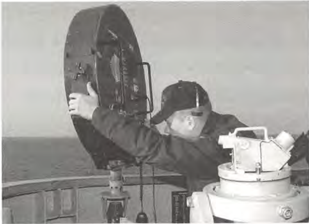
صورة جهاز صوتي بعيد المدى، استُخدم على ظهر السفينة الأمريكية بلوريدج، في أثناء تمرين هجومي بالزوارق الحربية الصغيرة عام 2006م. المصدر: سلاح البحرية الأمريكي.
